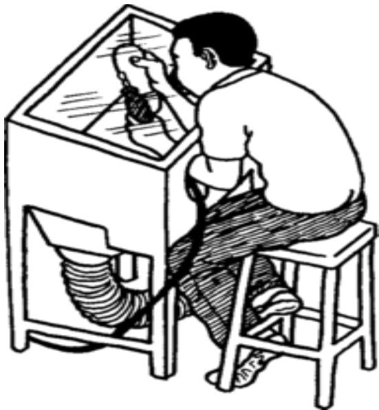
Hình 3.3. Giảm thiểu ô nhiễm bụi từ công đoạn mài
